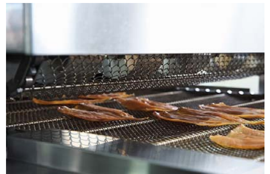
為了避免魷魚遇熱蜷曲，在上方加裝了抑制用的網帶
