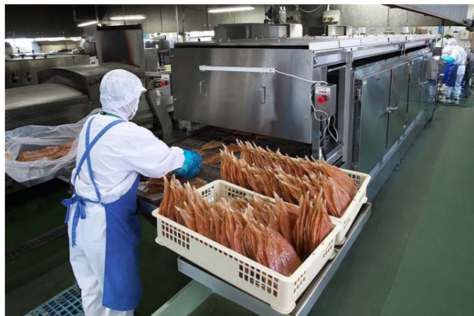
連續式噴射烤箱肩負著井上食品零食製作產品 7 成以上的烘烤
