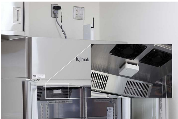
安装在 SHIMA 冰箱 / 冷冻柜的云端链接厨房传感器（附图 - 线条边框图片）和通信设备的母机（冰箱顶部）
