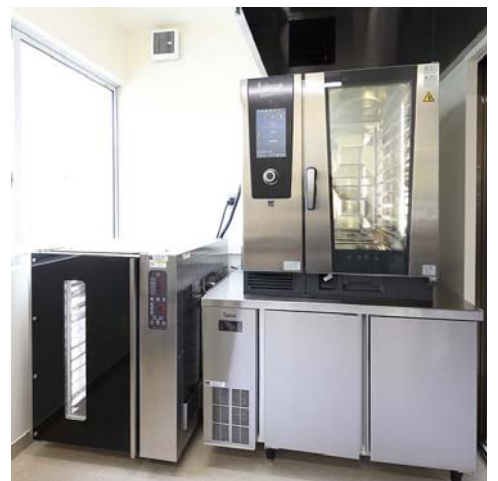
烘焙室。万能蒸烤箱，工作台式冷冻 / 冷藏冰箱之外，还引进了醒发箱，用于控制冷冻面团、现做面团的发酵。
