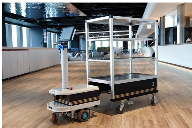
自主移动运输车。使用平板电脑操作的机器人(照片左)牵引着小推车(照片右)。机器人和小推车可以分离。
