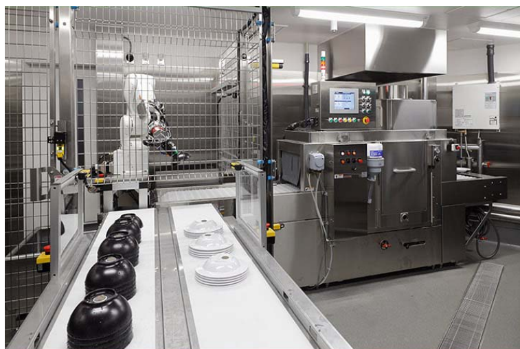
餐具自动分拣机器人 "finibo"。通过传感器识别从照片右侧的洗碗机里流出的已清洗完毕的餐具，吹干餐具底部线纹的水分后进行分拣，按照指定的方法分拣到近前的回收传送带上。
