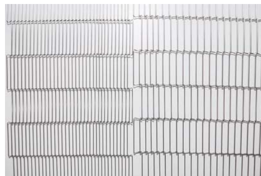
为了防止细小食材从传送带上掉下来，采用了最大直径为 7mm 的细眼传送带网（照片左侧）。
